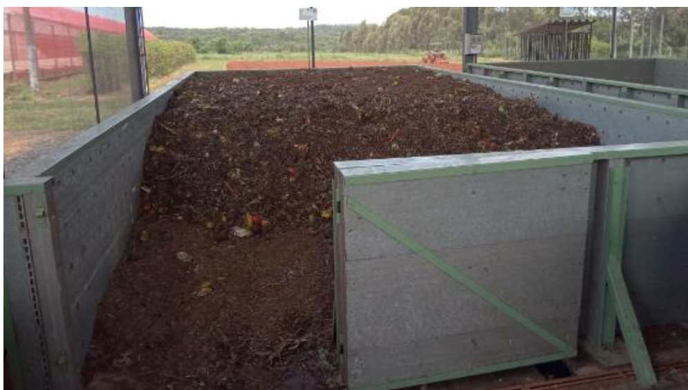
Foto 3 - Pilha Estática de compostagem com aeração forçada.
