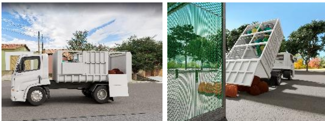
Figura 7 - Caçamba particionada adaptada para coleta simultânea de duas frações
